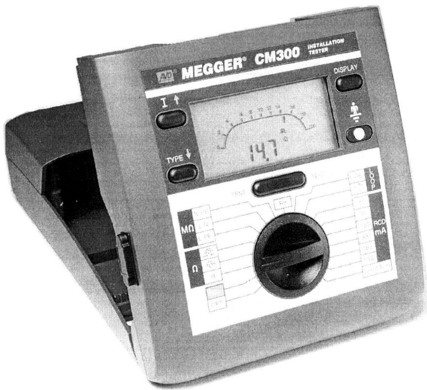
Slika 1: Višenamjensko mjerilo za mjerjenje i ispitivanje električnih instalacija
